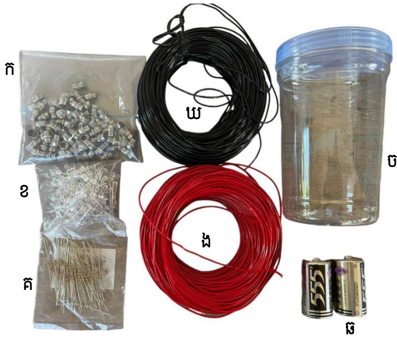
រូបភាព ក. ដើងទម្រង់អំពូលឌីយ៉ូត (អិលអ៊ីឌី) រូបភាព ខ. អិលអ៊ីឌី រូបភាព គ. វ៉ែលីស្ករ រូបភាព ឃ. ខ្សែភ្លើងពណ៌ខ្មៅ រូបភាព ង. ខ្សែភ្លើងពណ៌ក្រហម រូបភាព ច. កំប៉ុងជ័រ រូបភាព ឆ. ថ្មីពិល
